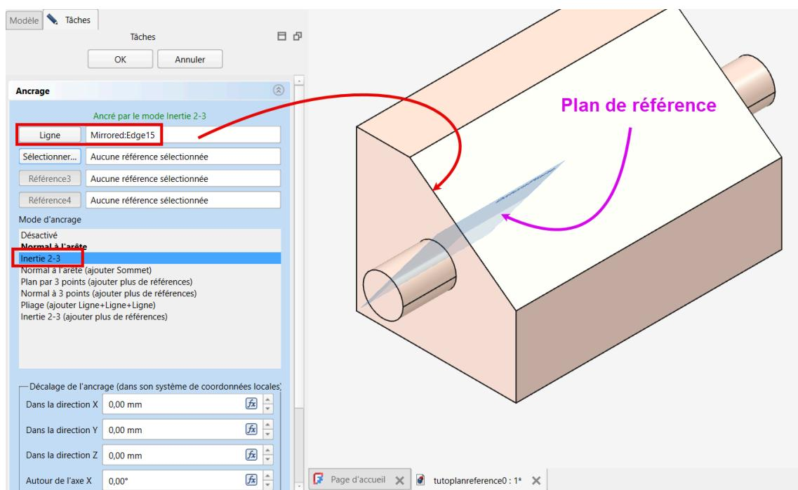
*Plan de référence perpendiculaire à une arête, origine au milieu de l'arête*
