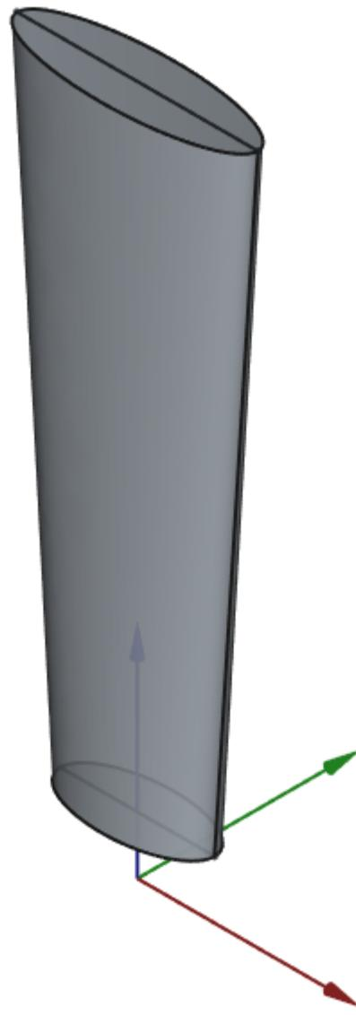
Dans un premier temps, il faut rechercher la cote Z du plan inférieur et du plan supérieur de ces ellipses.
